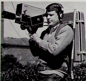
Bild 1. Tragbarer Ampex-Videorecorder „VR-3000“ für Transversalaufzeichnung mit Schwarz-Weiß-Handkamera „BC-300“
